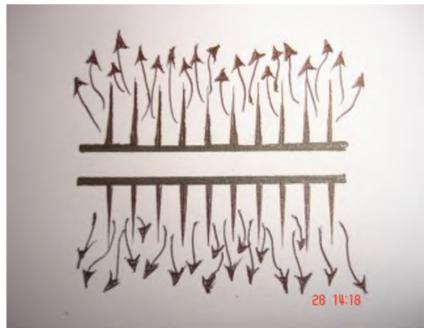
Hình 3.7: Đường ống tỏa nhiệt có bờ rìa.
